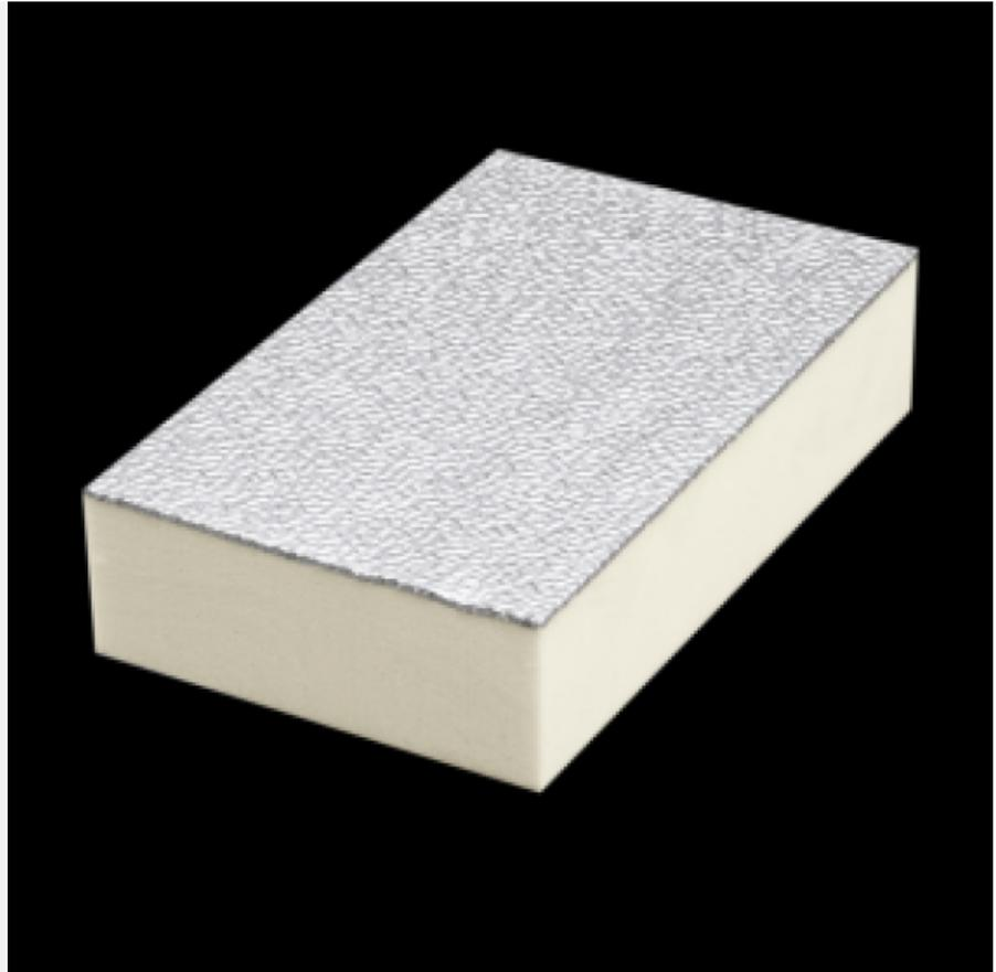
**POLIISO® AIR OUTDOOR GG200** es un panel sándwich compuesto por espuma rígida de poliiso (espuma de poliuretano) de célula cerrada de color amarillo, expandida entre dos soportes de aluminio en relieve: el de la cara exterior de 200  $\mu\text{m}$  y el de la cara interior de 80  $\mu\text{m}$ .
